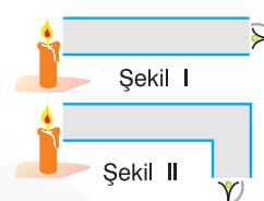
Şekil I'deki düz borunun bir tarafına konulan mum ışığını Ayşe borunun diğer ucundan görebilmektedir. Boru şekil II'deki gibi büküldüğünde Ayşe mum ışığını görmemektedir.
